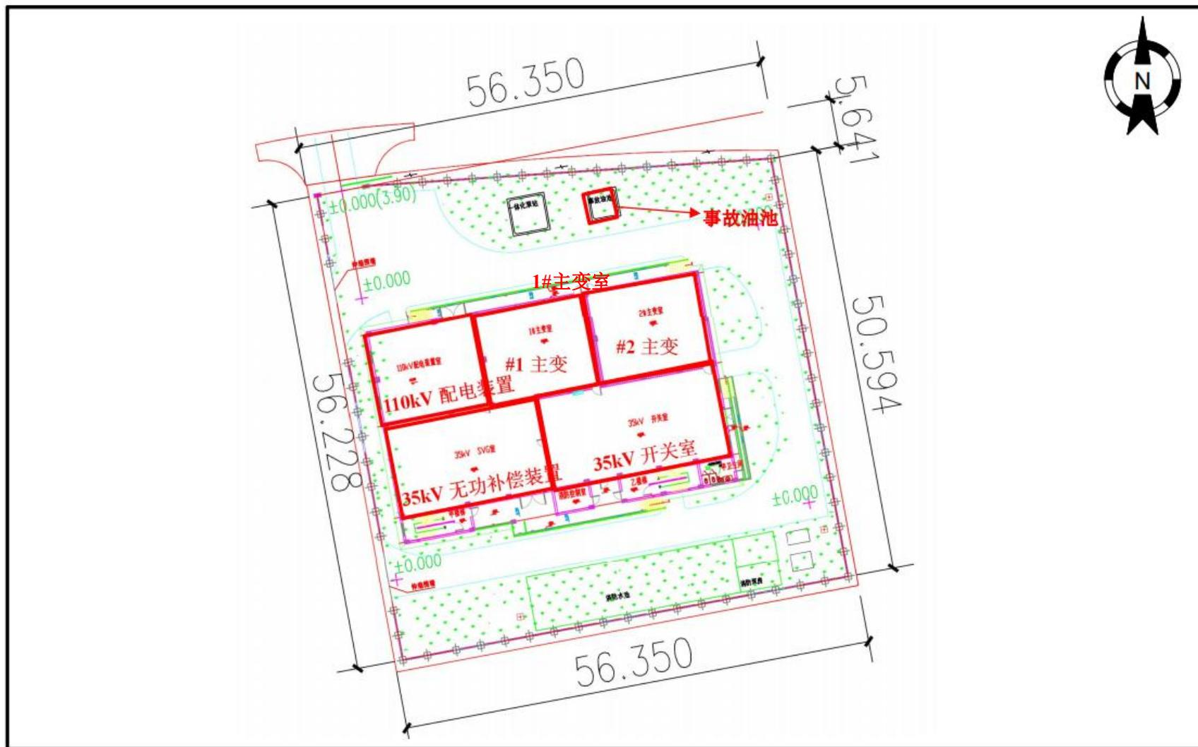
附图2 110kV 世纪大道变电站平面布置图 (1)
